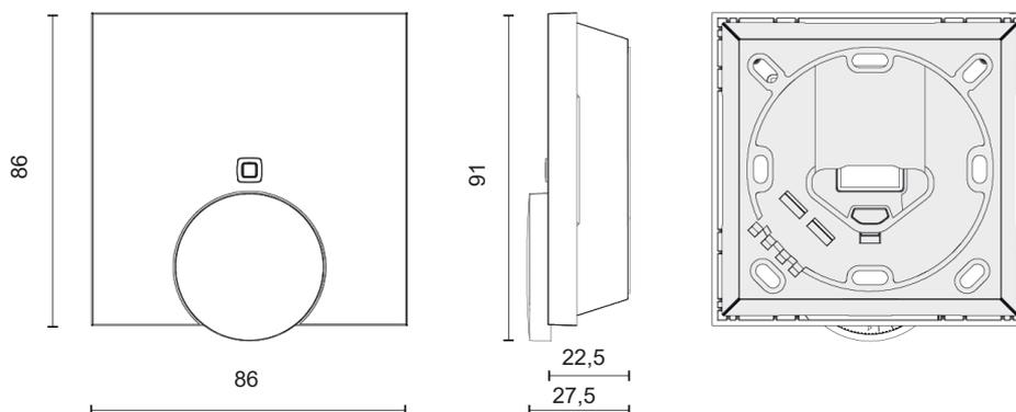
Abb. 1: Abmessungen Alpha IP Raumbediengerät Funk Analog (Angaben in mm)
